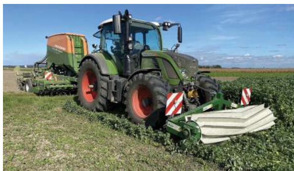
4.20. ábra: A traktor frontjára szerelt roller-crimper, amelyet a traktor mögött a vetőgép követ. Fotó: GRAND FARM
