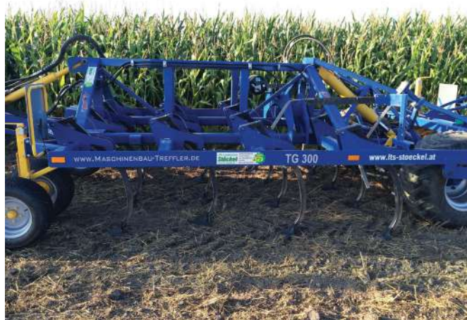
4.17. ábra: Kultivátor - a csökkentett talajművelés eszköze (művelés 4 cm mélyen).
