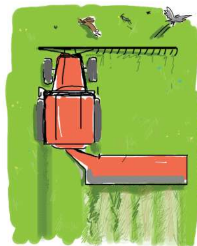
4.4. ábra: Láncfüggönyös vadriasztóval felszerelt kaszálógép sematikus működése.
